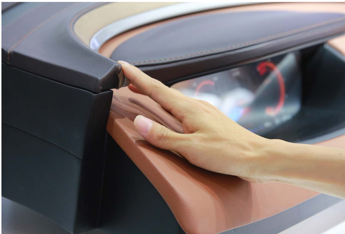
Haptex® 聚氨酯人造皮革用於包覆汽車儀錶板。
